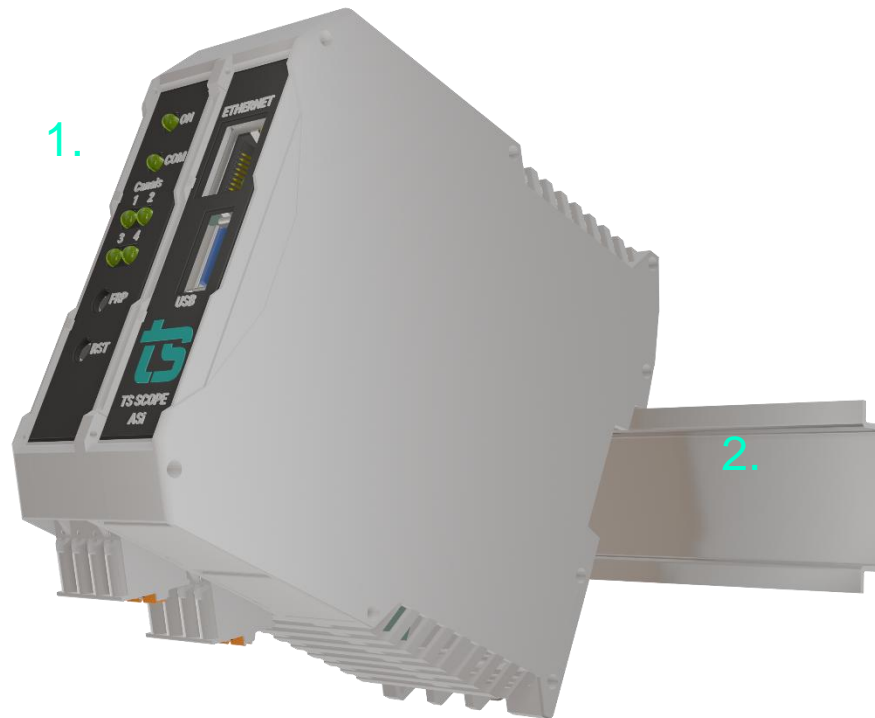
Figura 2: Instalação do TS Scope ASI
