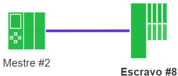
Figura 7: Conexão PROFIBUS DP estabelecida entre mestre e escravo
